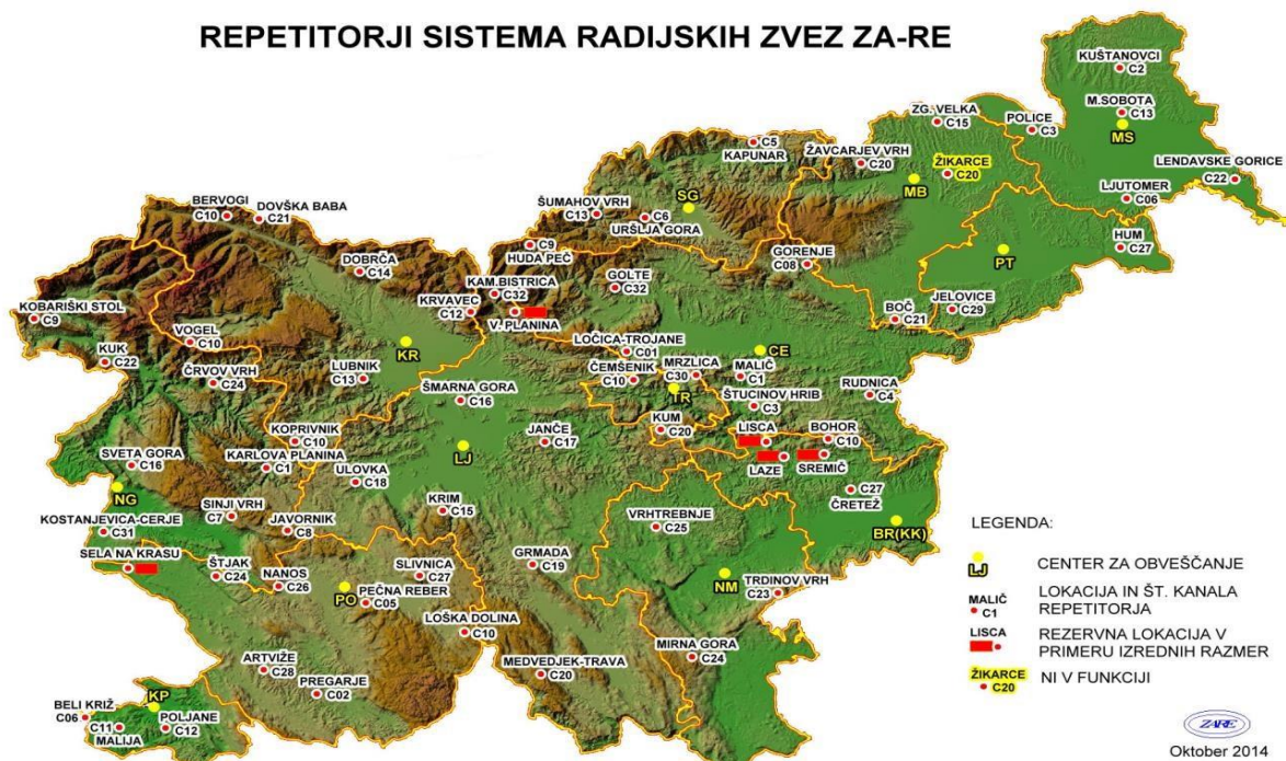
Slika 9: Repetitorske postaje s kanali sistema ZA-RE
