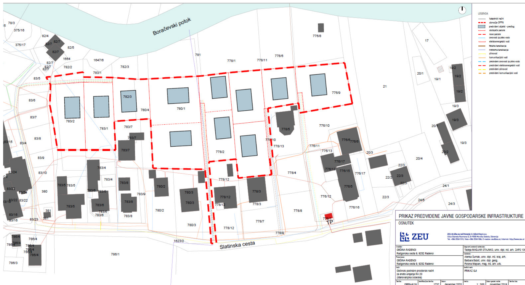
Slika 5: Prikaz ureditve glede poteka omrežij in priključevanja na gospodarsko javno infrastrukturo (vir: OPPN)
