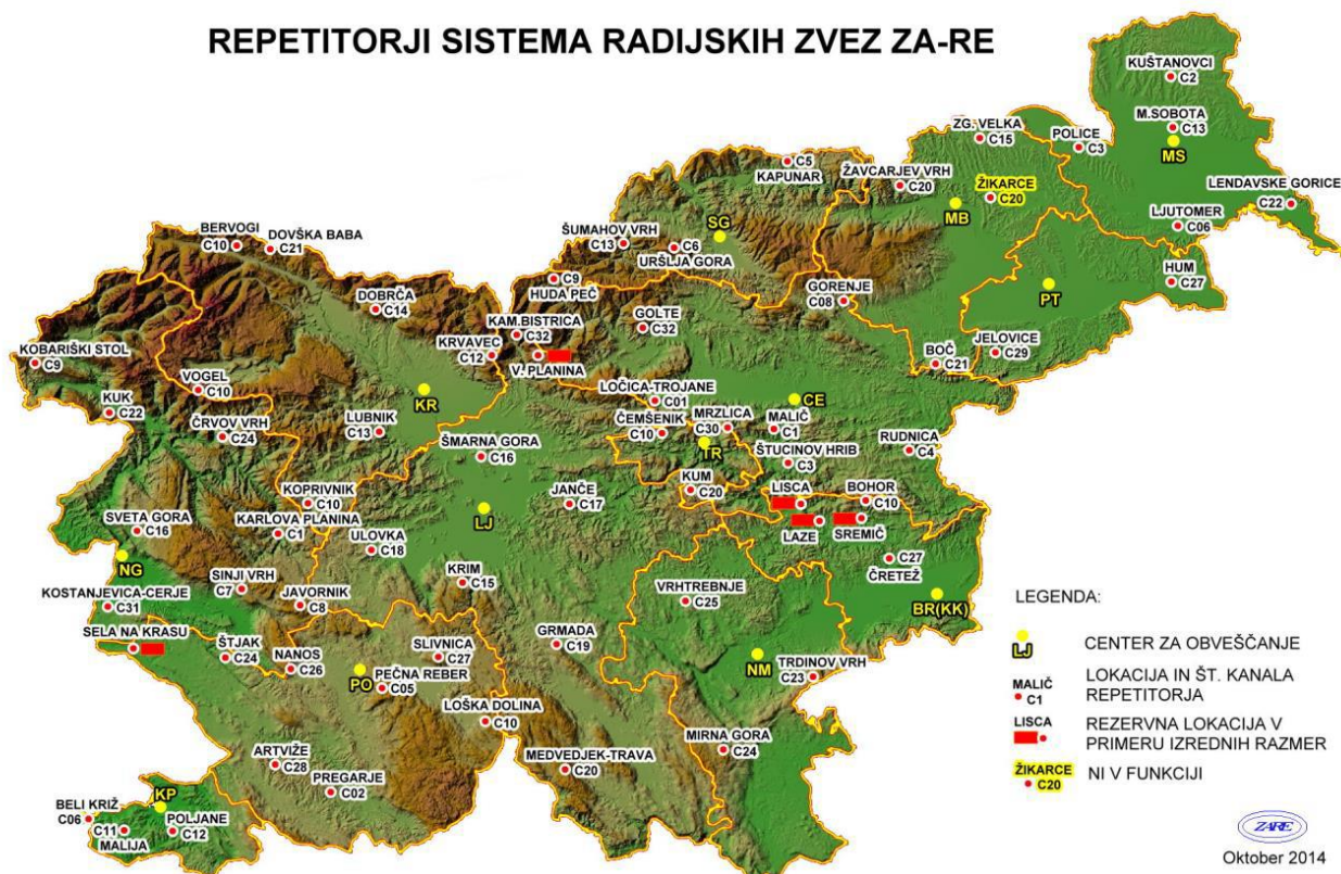
Slika 6: Repetitorske postaje s kanali sistema ZA-RE
