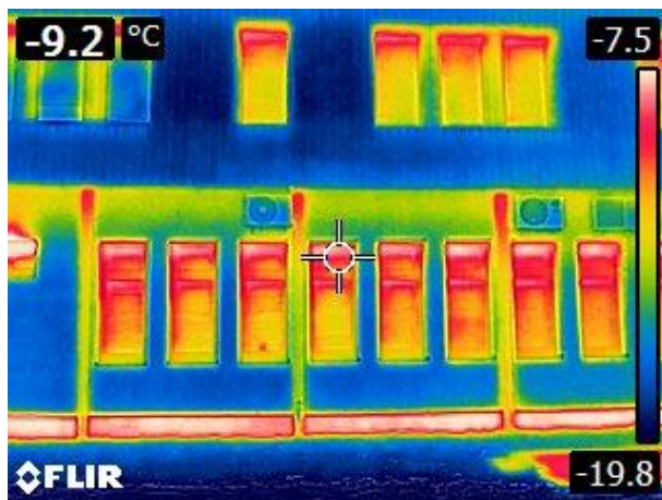
Slika 5: Termografski posnetki ovoja zgradbe
