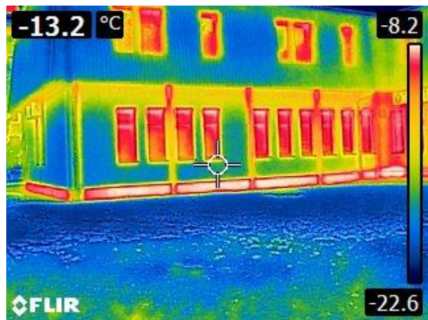
Slika 5: Termografski posnetki ovoja zgradbe
