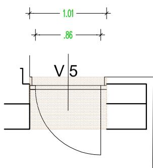
Notranja PVC vrata, enaka kot obstoječa dim. 101/201 + 61 cm nadsvetloba, s PVC podbojem, vratno krilo v spodnjem delu do višine 68 cm PVC polnilo, ostalo zastekljeno s termopan varnostnim steklom, nadsvetloba zastekljena s termopan sterklom, Rw 32 dB, vratna prepira višine 1,0 cm, ali brez, trojna nasadila, okovje standardno, kljuka inox, cilindrična ključavnica, sistemski ključ, vključno z vsem pritrdilnim in tesnilnim materialom ter transporti
