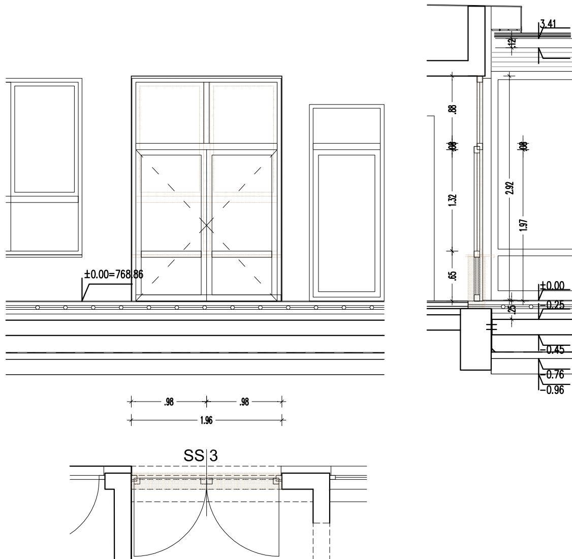
Dvokrilna PVC vrata, enaka kot obstoječa okna in vrata , s PVC podbojem, trojna nasadila, okovje standardno, kljuka inox, cilindrična ključavnica, sistemski ključ, vključno z vsem pritrdilnim in tesnilnim materialom ter transporti
