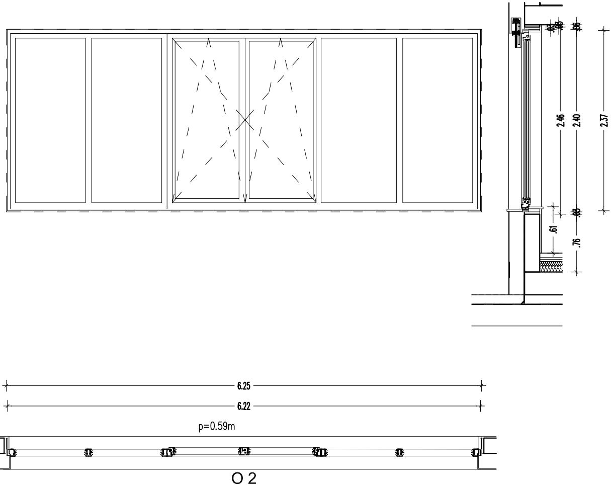
Zunanje okno sestavljeno iz 3x dvokrilno leseno okno, kot npr. les - M Sora - Natura optimo ali enakovredna , zunanja žaluzija na ročni pogon kot npr. Senčila Bled ali enakovredna, zastekljeno s troslojnim, izolacijski,m varnostnim steklom 4-14-4-14-4-s toplim robom s plinskim polnjenjem,  $U_w = 0,9 \text{ W/m}^2 \text{ K}$ , suhomontažna vgradnja po sistemu RAL, okovje standardno, kljuka inox, vključno z vsem pritrdilnim in tesnilnim materialom ter transporti
