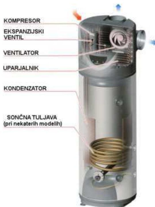
Slika 72: Sodobna toplotna črpalka z zalogovnikom za pripravo tople sanitarne vode (vir: www.http://toplotna.si )
