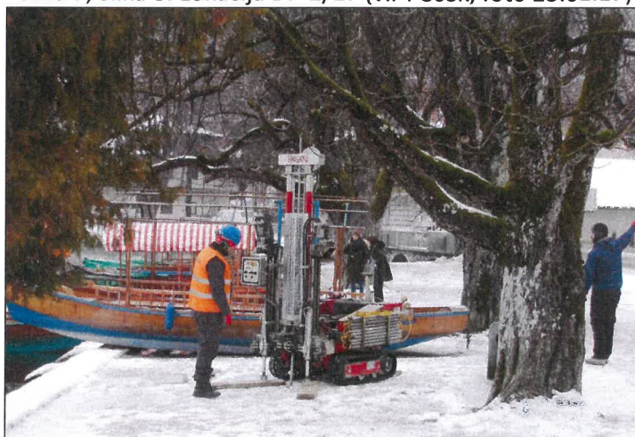
Slika 9: Garnitura Pagani za dinamično sondiranje od blizu
