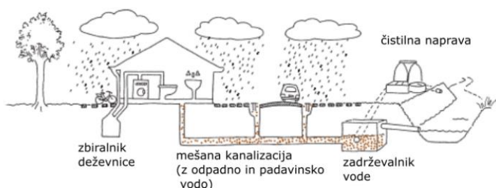
Prilagojeni mešani kanalizacijski sistem
