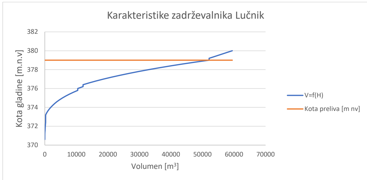
Slika 26: Grafikon s prikazom volumske krivulje v odvisnosti od nadmorske višine gladine za zadrževalnik Lučnik
