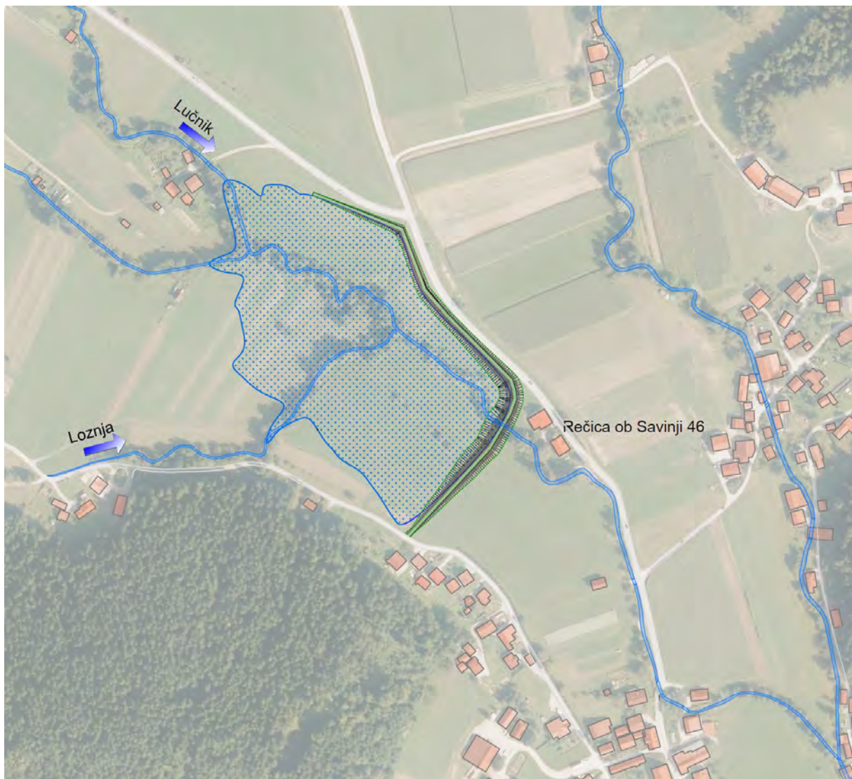
Slika 28: Tlorisna umestitev suhega zadrževalnika na vodotoku Lučnik severno od naselja Rečica – Varianta 0.
