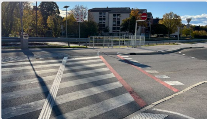
Slika 13: Prehod za pešce s taktilnimi označbami za slepe in slabovidne na Radgonski cesti, na vhodu na avtobusno postajo Radenci
