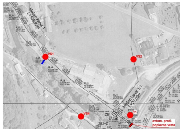
slika 16: skica namestitve vrtinčnih separatorjev VS1 in VS2
