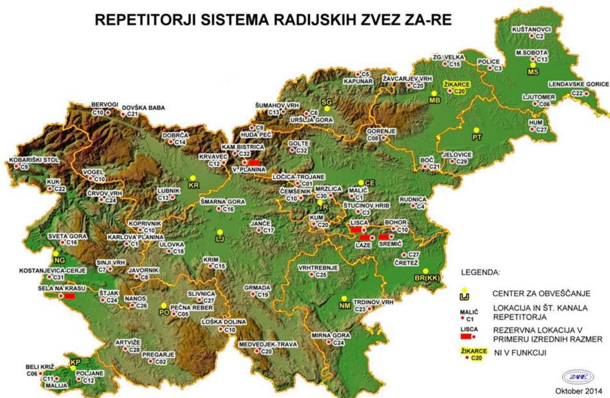
Slika 7-1: Repetitorske postaje s kanali sistema ZA-RE
