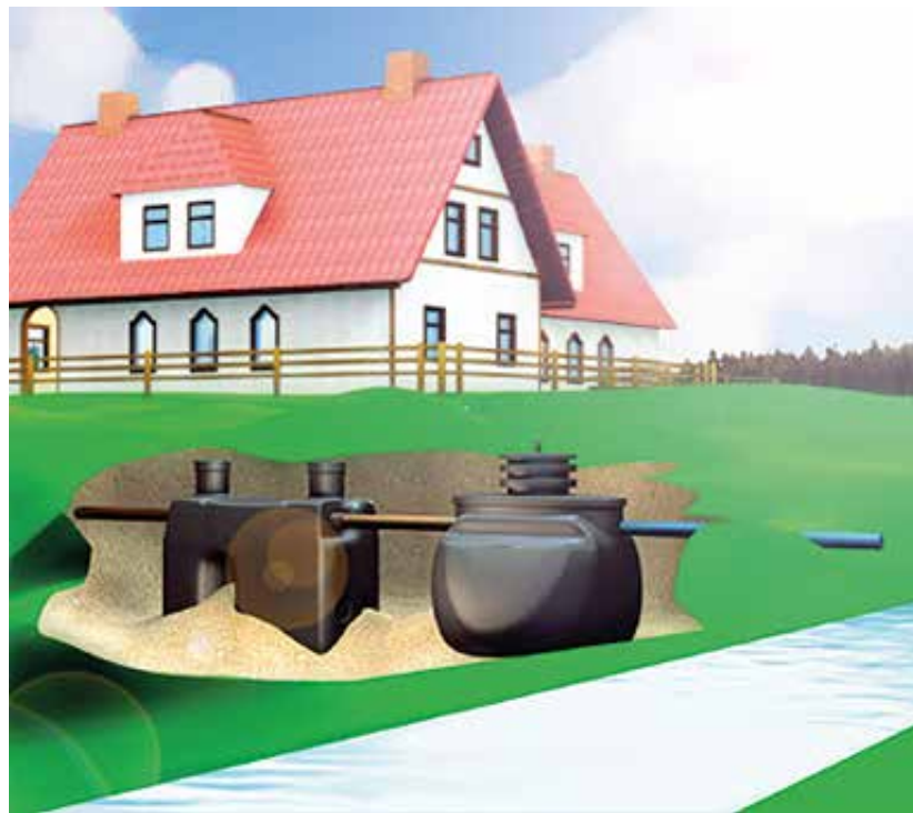
Vgradnja malih komunalnih čistilnih naprav
