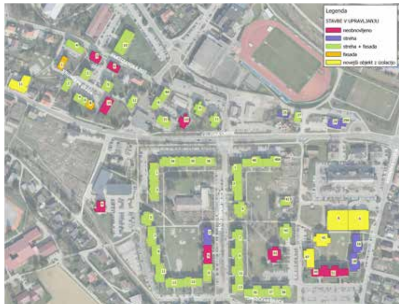
Pregled energetske obnove stavb v naselju S8
