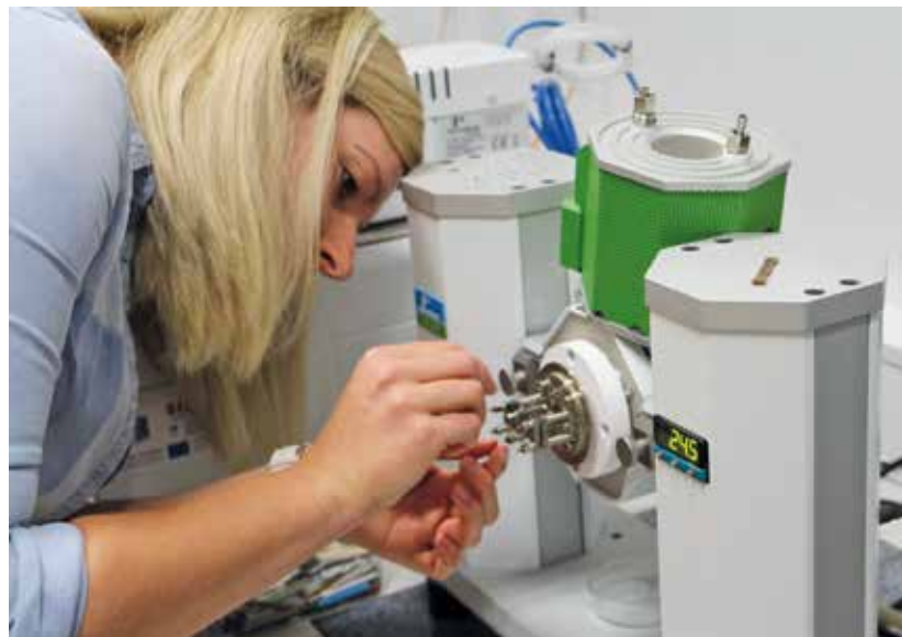
Diplomantka FTPO Tadeja Rožanc pri delu z Dinamičnim mehanskim analizatorjem. (foto arhiv FTPO)
