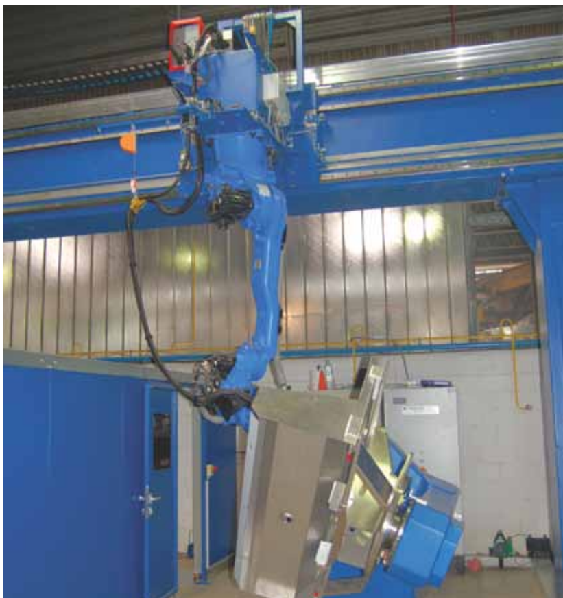
Najnovejša investicija podjetja – varilni robot s t. i. robotskim vidom
