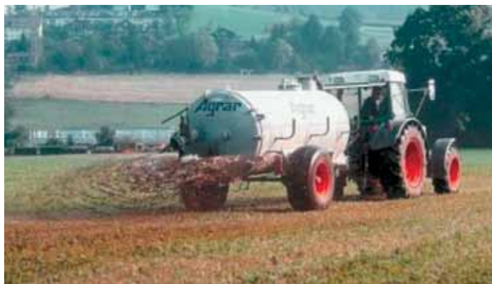
Kadar odbojna plošča odbija gnojevko proti tlom, so izgube že precej nižje in tudi smrad je znosnejši.
