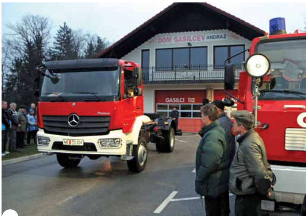
Novo vozilo je narejeno na podvozju znamke Mercedes-Benz 1530 AF 4 x 4.
