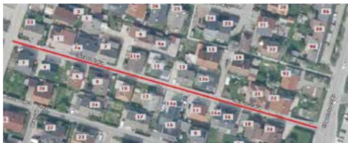
Odsek Ulice dr. Zajca, kjer trenutno poteka obnova vodovoda, kanalizacije, cestišča in hišnih priključkov.
