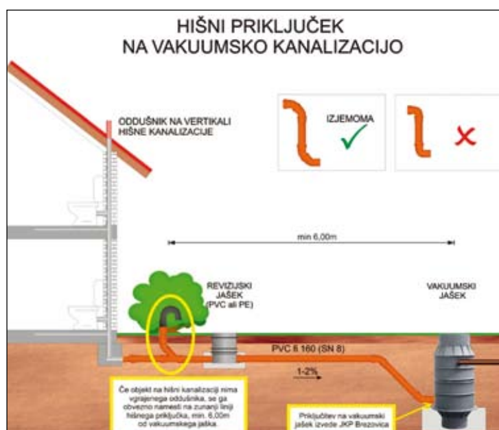
Slika 1: Hišni priključek na vakuumsko kanalizacijo (Vir: JKP Brezovica) Po opravljeni izgradnji kanalizacijskega kanala od revizijskega do vakuumskega jaška, se obvesti JKP Brezovica, da izvede priključitev na vakuumski jašek. Tako stanje počaka na obvestilo, da je možen fizični prekop fekalnih voda v revizijski jašek, katerega opravi strokovna oseba s strani JKP Brezovica in izda ustrezno potrdilo o priklopu.
