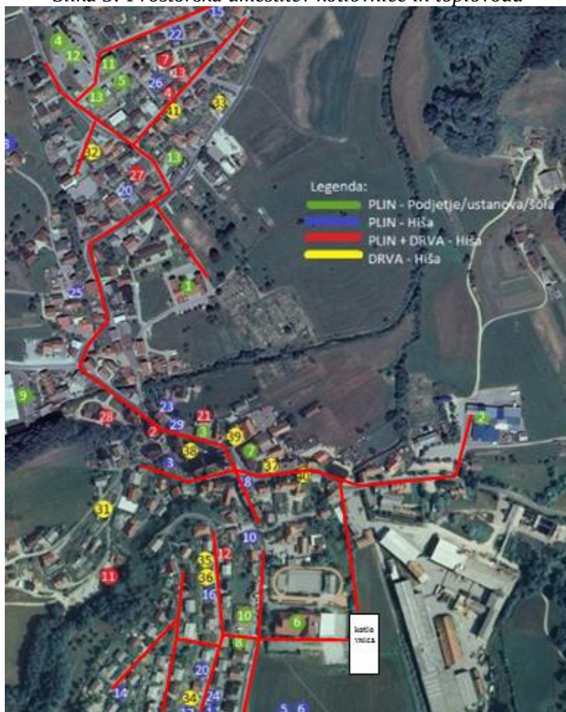
Slika 5: Prostorska umestitev kotlovnice in toplovoda
